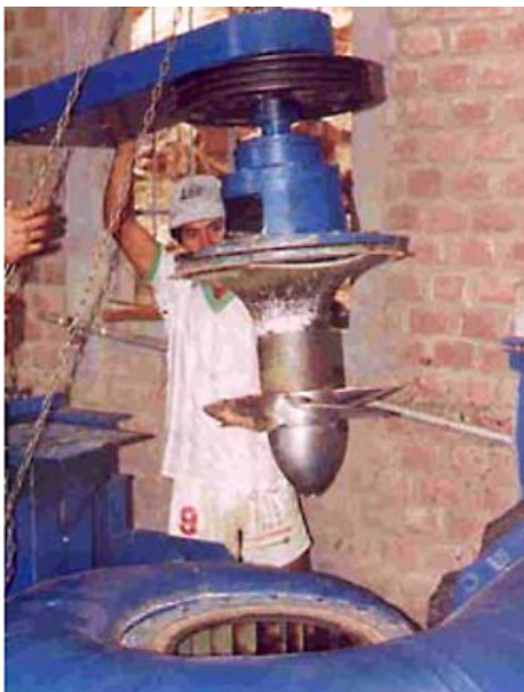
Evaluación de la turbina después de 25,000 horas de funcionamiento.
